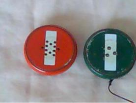
Diese Kapseln kann man leicht identifizieren, indem nan den Gleichstrom- Widerstand misst: er ist 42 Ohm bei 20 ° C.
