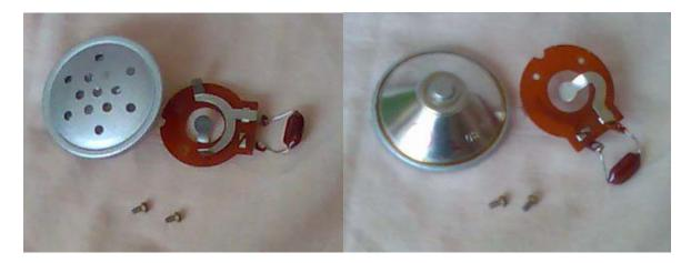
Dann wird er kleine Verstärker auf die Rückseite der neuen Kapsel installiert. Entweder man benutzt Eine selbstgebaute Platine, oder man lötet die Komponenten mit ihren Drähten zusammen. Zum Schluss muss zum richtigen Anschluss + und – der Mikrofonverbindung im Hörer gefunden werden- z.B. indem man mit dem Ohmmeter Die Verbindung zum Chassis ausmisst.
